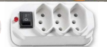
Tomada com 3 Saídas , em termoplástico polipropileno. Luz led indicativa. Corrente máxima: 10 A em 250 V. Não possui USB. Tam.: 10 cm. cód. 6.550.284
